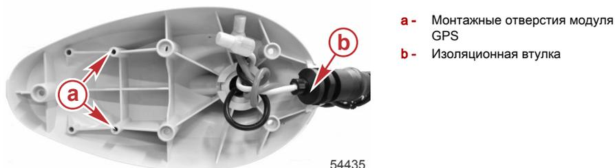
4. Установите верхний модуль GPS на головную часть двигателя малого хода, как показано на рисунке, чтобы кабель GPS выходил из модуля снизу. Зафиксируйте верхний модуль GPS на головной части двигателя малого хода двумя монтажными винтами. Сдвиньте провода питания в одну сторону для облегчения установки кабеля GPS. Проложите кабель GPS от головной части двигателя малого хода через прорезь в изоляционной втулке, как показано на рисунке.
