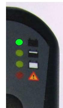
Если напряжение падает до 12.5В или ниже, начнётся новый процесс заряда. Процесс заряда также начнётся после истечения одной
