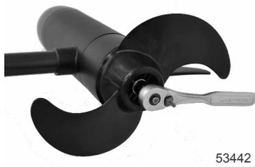
4. Затяните гайку гребного винта еще на  $\frac{1}{4}$  оборота.
